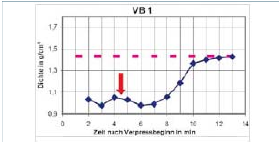
Abb. 8: Entwicklung der Suspensionsdichte (gestrichelt: Dichte im Mischer, durchgezogene Linie: Dichte im Rücklauf, Pfeil: erkennbarer Farbumschlag beim Verpressen) (Quelle: W1/01/02 Untersuchungen zur Bestimmung der Qualitätskriterien für Abdichtungsmaterialien im Brunnenbau, DVGW, März 2003)
