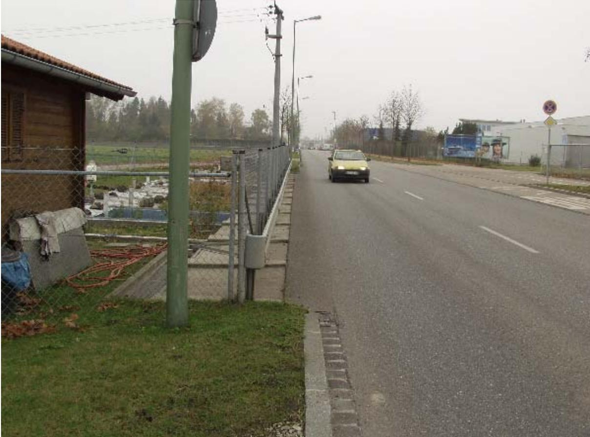
Bild 2: Versuchsanlage Augsburg, Derchingerstraße, Blick stadteinwärts. Die Betonborde am 1,3 m breiten Bankett grenzen die 14 Untersuchungsfelder von je 2 m Breite gegeneinander ab.
