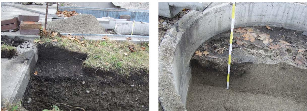
Bild 18: Sedimentbildung; linke Hälfte: F 10; Sedimentkeil am Straßentiefpunkt; rechte Hälfte: ASANDU; zulaufnahes Sedimentmuster verursacht durch turbulente Strömung
