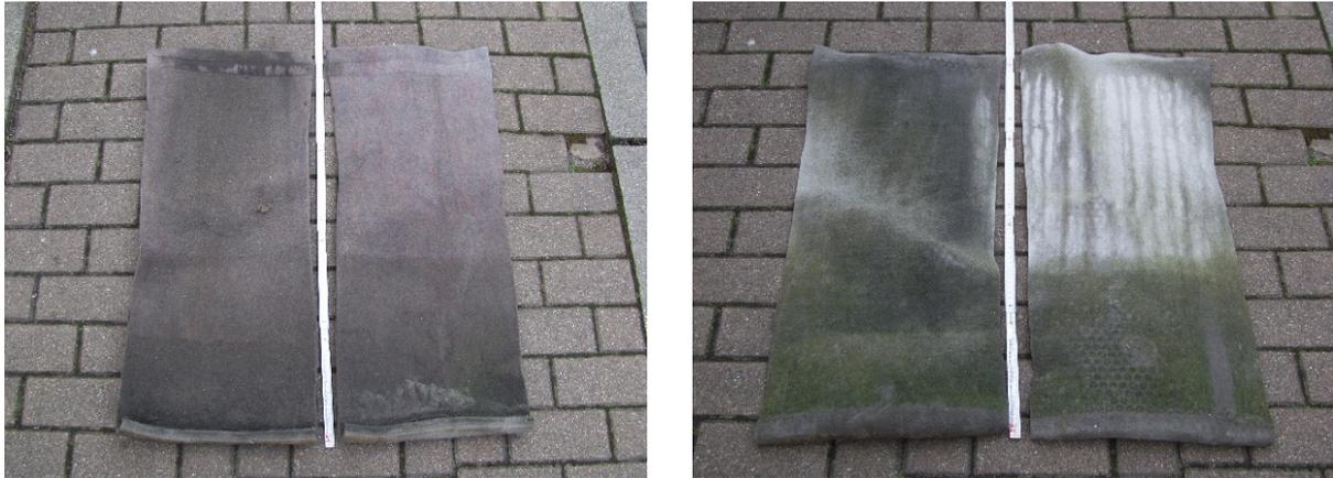
Bild 10: Linkes Bild zeigt die Innenseite des Filtersackes links zulaufnah und rechts zulauffern. Die zulaufnahme Seite zeigt auch am oberen Rand Sedimenteinträge, vermutlich durch kleine Zuflüsse verursacht. Rechtes Bild zeigt die gleichen Filtersackstreifen wie linkes Bild von der Außenseite. Die zulaufnahme Seite (links) zeigt im oberen Teil deutlich höhere Sedimenteinträge als der zulaufferne rechte Teil
