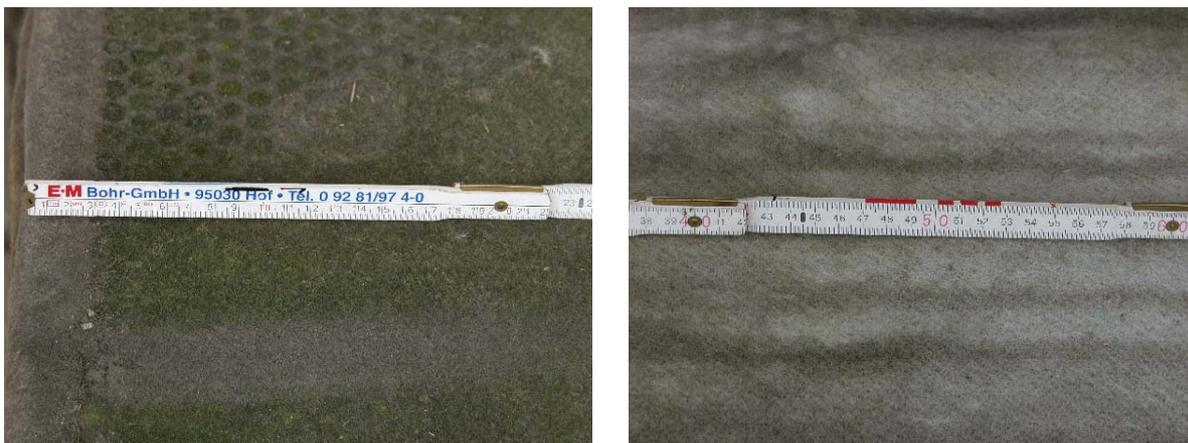
Bild 9: Außenseite des Filtersackes. Die unteren 30cm (linkes Bild) zeigen eine deutliche Sedimenteinsparung mit Abdrücken der Lochblechhalterung (siehe Bild 8). Im oberen Teil (rechtes Bild) sind hingegen von außen keine Sedimenteinsparungen erkennbar.
