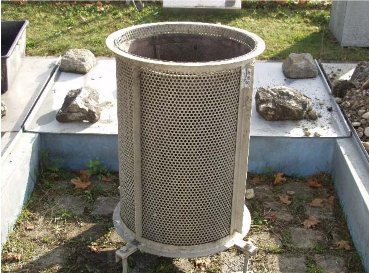
Bild 8: Geotextilsack AGEOU im ausgebauten Zustand, um die hydraulische Leitfähigkeit messen zu können. Eventuell hat die an die Lochblechhalterung anliegende Filtersackwand Einfluß auf die Hydraulik
