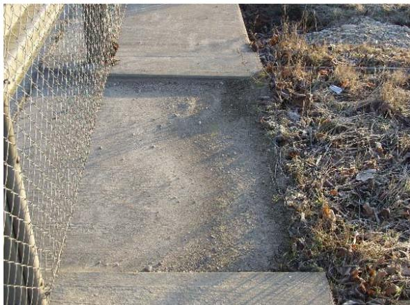
Bild 16: Sediment des Betonbankettes von Feld 12. Aufgrund des in diesem Feld aufgewachsenen, zulaufnahen, keilförmigen Lysimetersedimentes konnte sich seit der letzten Räumung im November 2005 auch fernes Sediment auf dem Betonbankett bilden. Der Sedimentbedingte Zuflussstau führte zu einer Vergleichmäßigung des Zuflusses über die Lysimeterbreite
