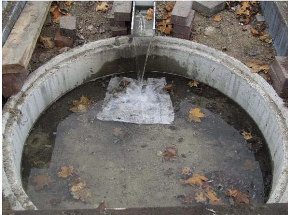
Bild 4: Einstau der Variante ASANDU für die  $k_f$ -Bestimmung und den Überstautracerversuch. Zur Verhinderung der Erosion wurde ein Tuch ausgelegt. Während des 4jährigen Betriebes bildete sich keine separate Sedimentschicht aus.
