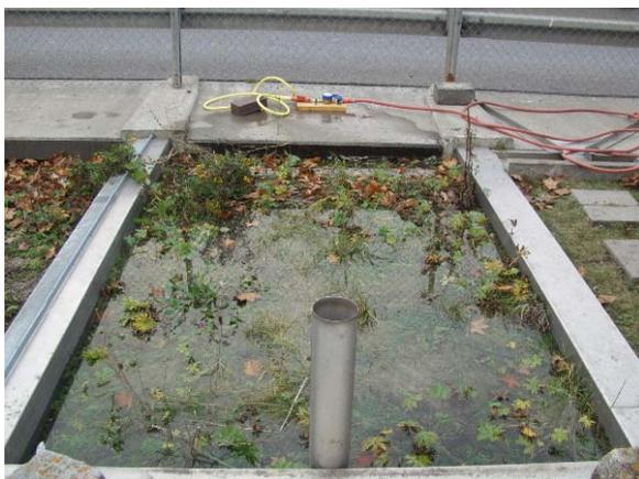
Bild 3: Einstau der Variante SR 75 für die  $k_f$ -Bestimmung und den Überstautracerversuch
