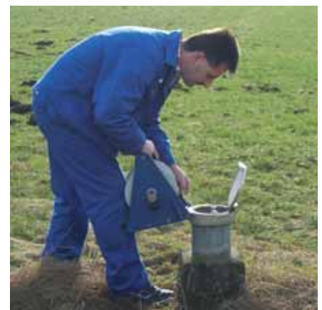
▲ Messung des Grundwasserstandes mit einem Lichtlot.
