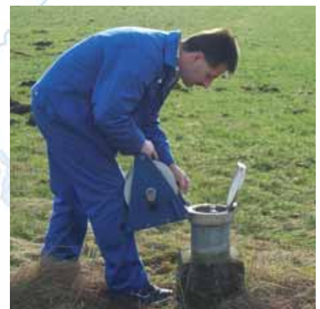
▲ Messung des Grundwasserstandes mit einem Lichtlot.
