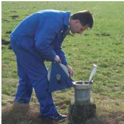
▲ Messung des Grundwasserstandes mit einem Lichtlot.
