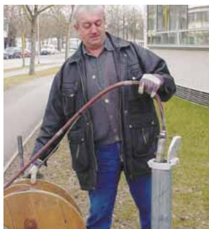
▲ Messung des Grundwasserstandes mit einem Lichtlot.
