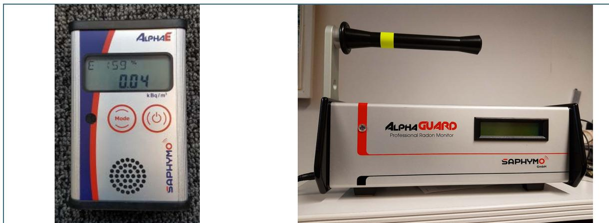
Abb. 3: Beispiele für zeitauflösende Radon-Messgeräte. Links: Messgerät „AlphaE“; Rechts: Messgerät „AlphaGuard“
