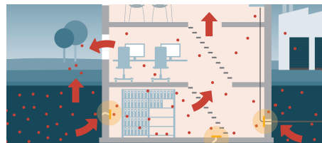
Abdichtungsmaßnahmen wie radondichte Folien im Fundamentbereich verhindern, dass Radon ins Gebäude eindringt.
