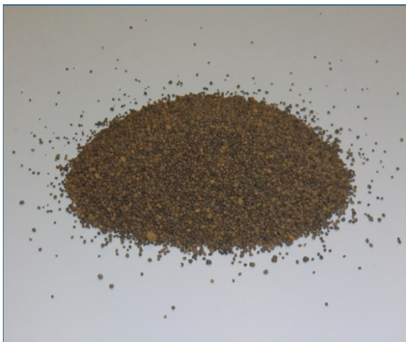
Abb. 22: gebrauchtes Filtermaterial mit Braunsteinanhaftungen
