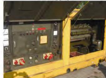
Bild 5: geöffnetes Dieselaggregat mit Schalttafel
