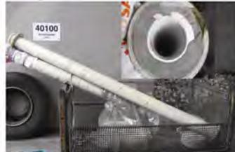
Bild 3: Rohre mit Bentonitauskleidung
