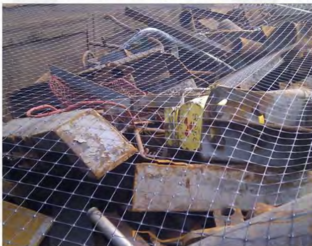
Noch nicht bekannte Quelle, Ermittlungen laufen Co-60; 22 µSv/h; ca. 20 MBq (Abschirmung) Gewicht ca. 60 kg
