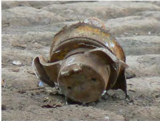
Füllstandsmesser mit defekter Abschirmung Cs-137; 40 mSv/h ; 10 GBq
