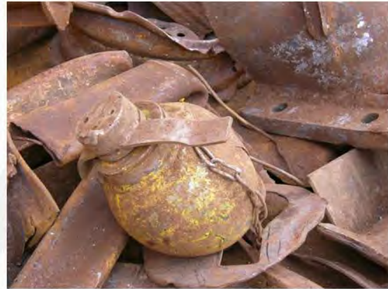
Füllstandsmesser mit Abschirmung Cs-137; 100 µSv/h ; 10 GBq
