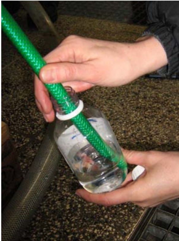
Abb. 3: Entnahme von Radonproben Beschriftung
