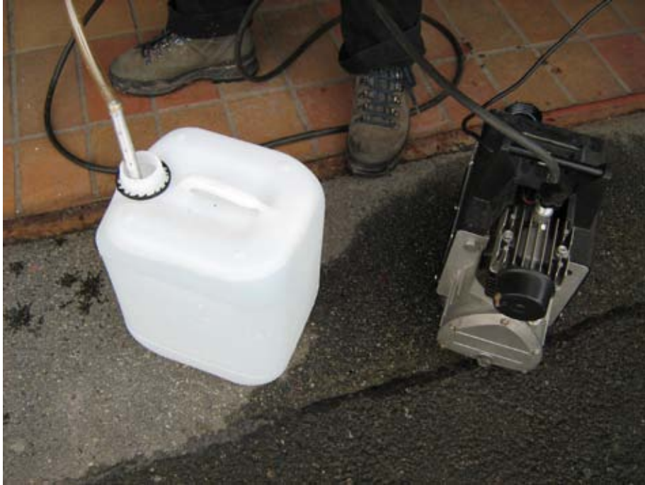
Abb. 4: Belüftung zur Entfernung von Radon aus der Probe
