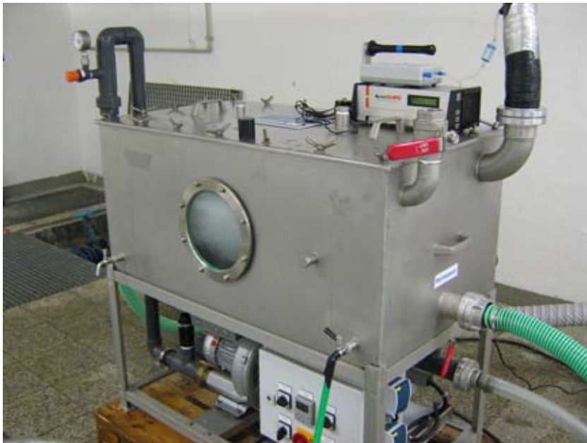
Abb. 39: Versuchsanlage zur Entfernung von Radon aus dem Wasser
