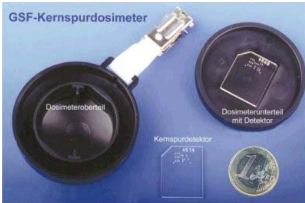
Abbildung 12.1: Kernspurexposimeter des GSF-Forschungszentrums zur Erfassung von Radonexpositionen.
