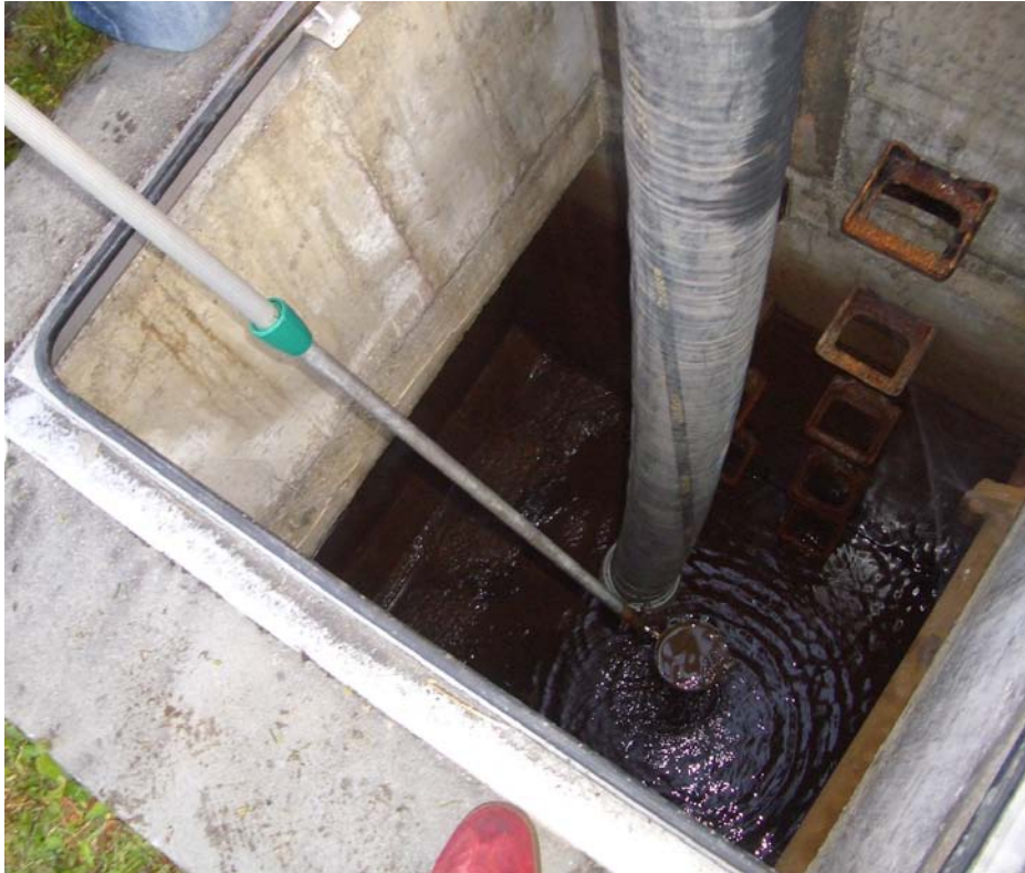
Abb. 1: Probenahme vor Ort aus einem Schacht
