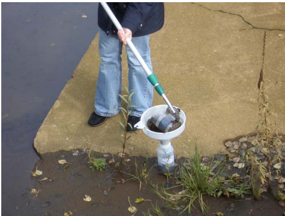
Abb. 2: Probenahme vor Ort aus einem offenen Absetzbecken
