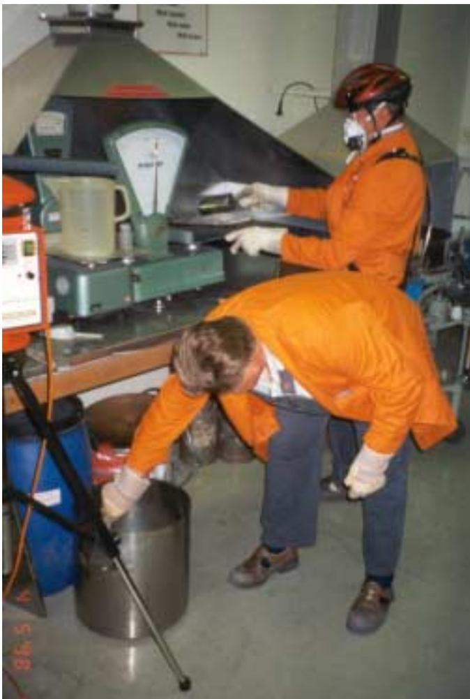
*Abbildung 11.1: Abwiegen und Auflösen des Thoriumnitrats (Dopraum)*
