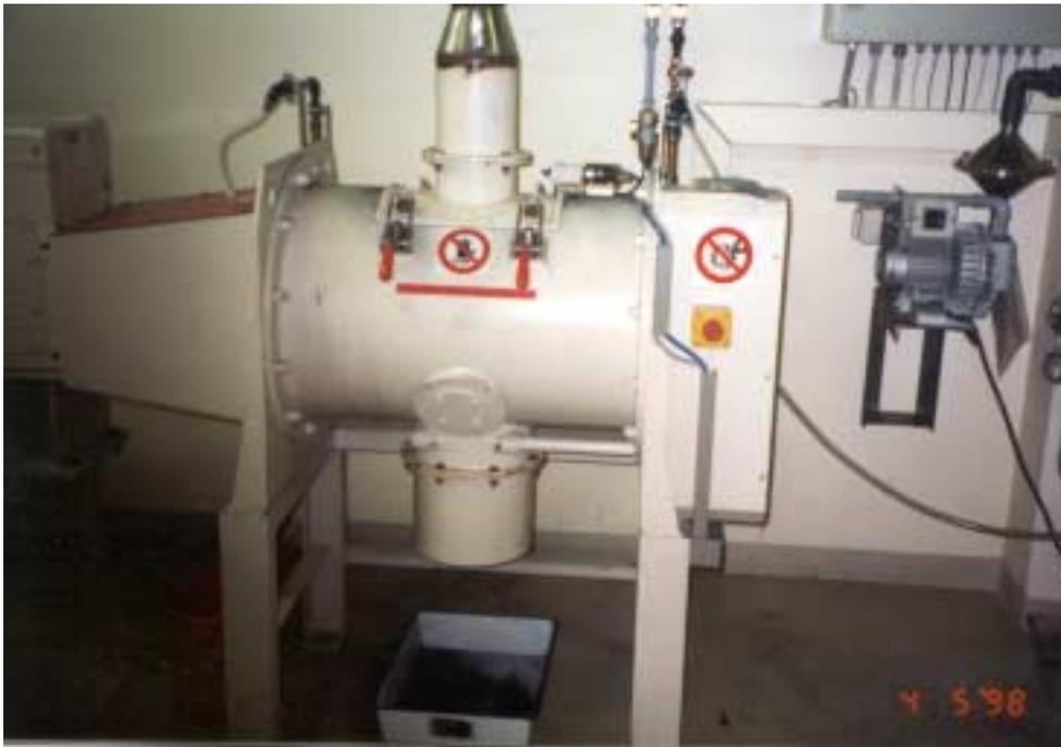
*Abbildung 11.2: Mischer zum Durchmischen und Benetzen (Doproium)*
