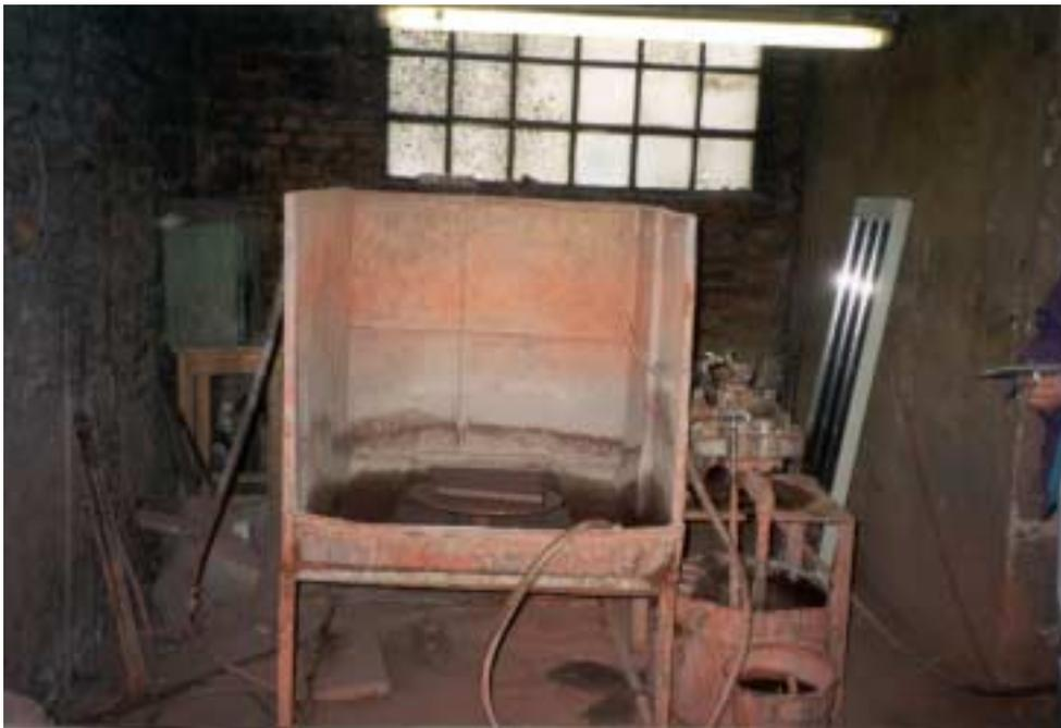
*Abbildung 10.2: Schlichtestation zum Aufsprühen der Schlichte*
