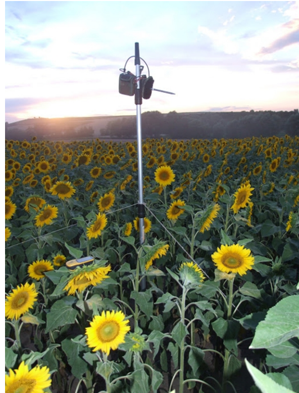
Abb. 30: Ein Batcorder dokumentiert über die Lautaufnahmen die Jagdaktivität von Fledermäusen über dem Sonnenblumenfeld.
