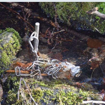
Ein Logger misst fortwährend die Temperatur.
