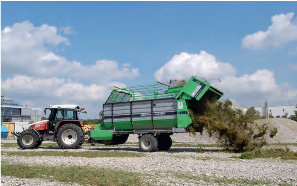
Abb. 32: Auf großen Flächen kann die Mahdgut-Übertragung maschinell erfolgen. Hier wird das Material mit allen Samen, Insekten und Kleinlebewesen auf einer Rohbodenfläche aufgebracht. Ein Lebensraum wird „kopiert“
