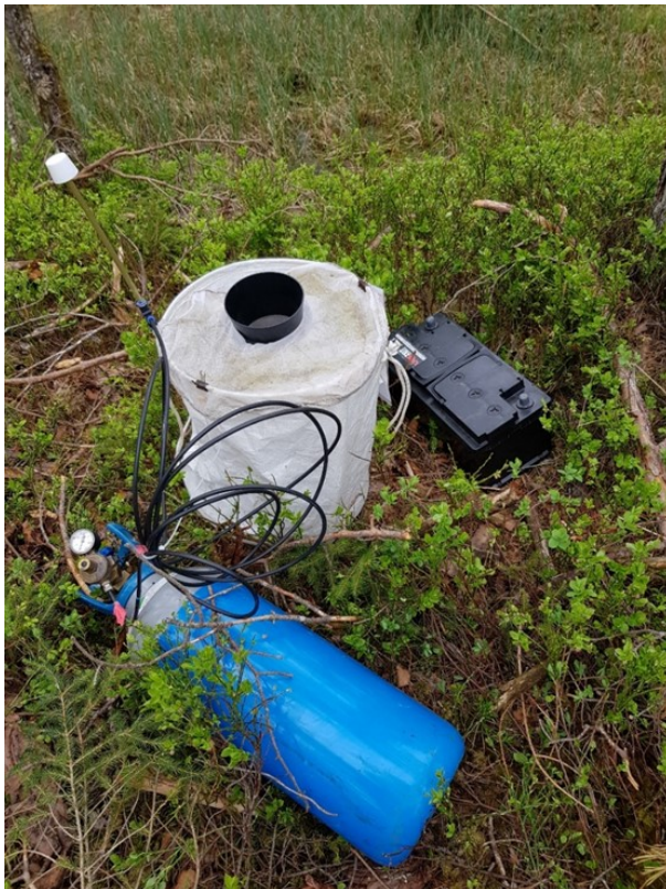
Abb. 10: In der Studie verwendete Falle (BG-Sentinel, Firma Biogents) mit CO 2 -Flasche (Firma Unterbichler) und Autobatterie
