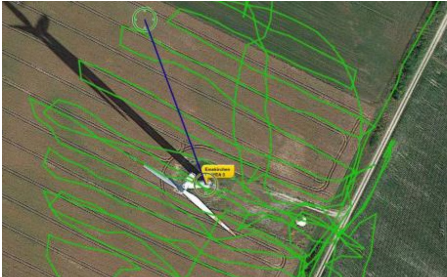
Abb. 2: Beispielhafte Darstellung einer Schlagopfersuche im 100 m-Radius um die WEA
