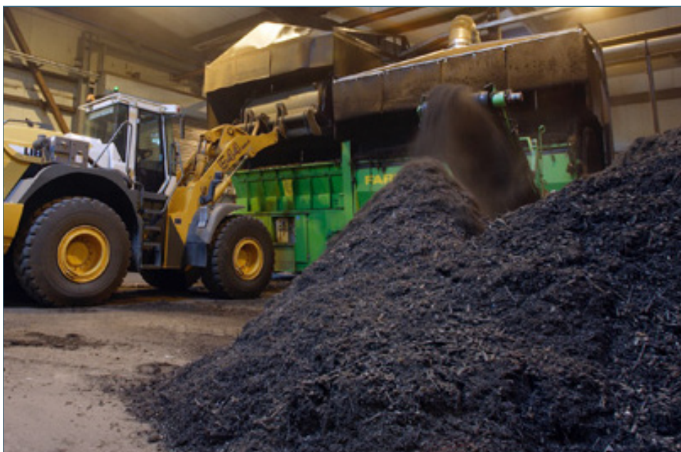
Abb. 7: Kompostwerke optimieren die Kompostierung. In den Kompostmieten steigen die Temperaturen so hoch, dass die meisten Keime, Samen und Wurzelreste abgetötet werden.
