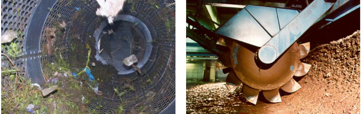
Abb. 28: Bioabfälle werden im Kompostwerk zerkleinert und in Kompost verwandelt. Dazu wird der Müll in einer Siebtrommel aussortiert (links). Während der Rotte wird der Kompost wöchentlich gewendet (rechts). Vor dem Verkauf wird der fertige Kompost streng auf Schadstoffe kontrolliert.
