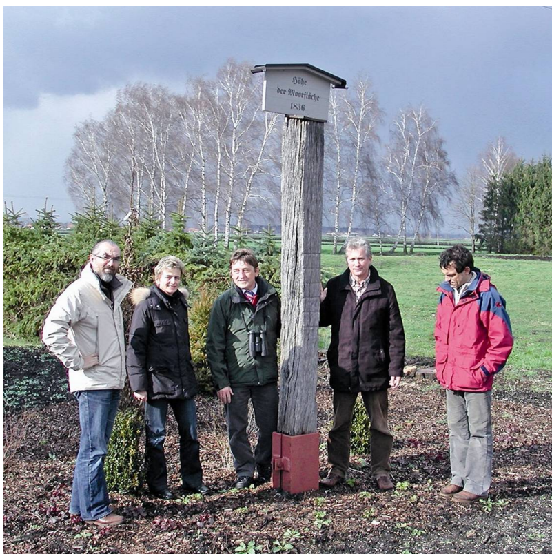
Abb. 9: Dieser Eichenpfahl im Donaumoos bei Neuburg zeigt, dass das Niedermoor heute um gut drei Meter niedriger ist als im Jahr 1836; damals reichte es noch bis zur Pegelspitze.
