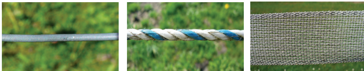
Abbildung 13: Verschiedene Litzenmaterialien. Links: Draht, Mitte: Seil mit eingeflochtenem Draht, Rechts: Band mit eingeflochtenem Draht.
