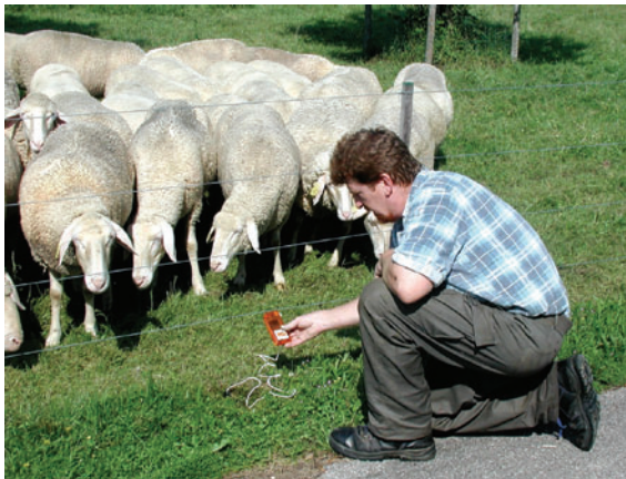
Abbildung 5: In der Regel ist täglich zu überprüfen, ob eine ausreichende Hütespannung von 4.000 V überall am Zaun anliegt.
