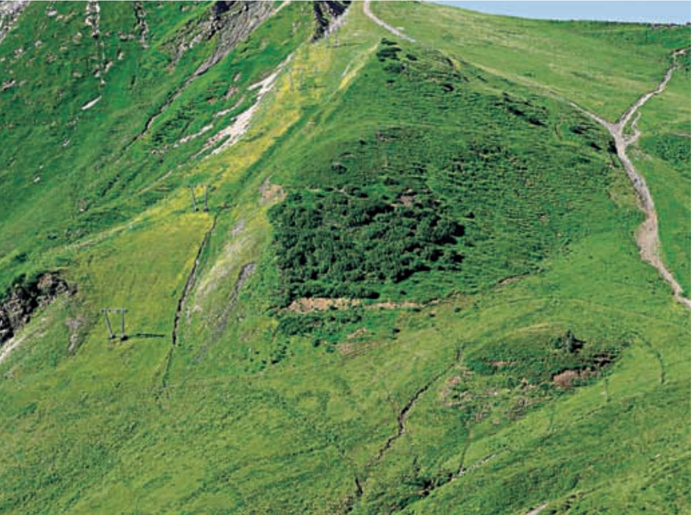
Foto 40: Deutlich unterscheidet sich die baulich veränderte Pistenfläche auch noch 25 Jahre später von der unveränderten „Insel“ in der Bildmitte. Hier ist das Relief grundlegend umgestaltet und nivelliert worden (OA16 Fellhorn im Jahre 1989).
