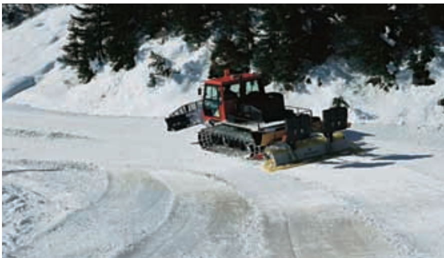
Foto 8: Pistenraupe im Einsatz. Mit dem Schild (vorne) wird der Schnee gleichmäßig verteilt, mit den Gleisketten verdichtet, mit der Fräse (hinten) gefräst, durchgearbeitet und abschließend mit dem Glättbrett geglättet.
