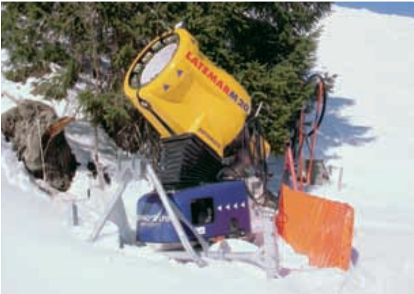
Foto 33: Moderne Propeller-Schneemaschine (Niederdrucksystem) im Einsatz (OA16 Fellhorn).
