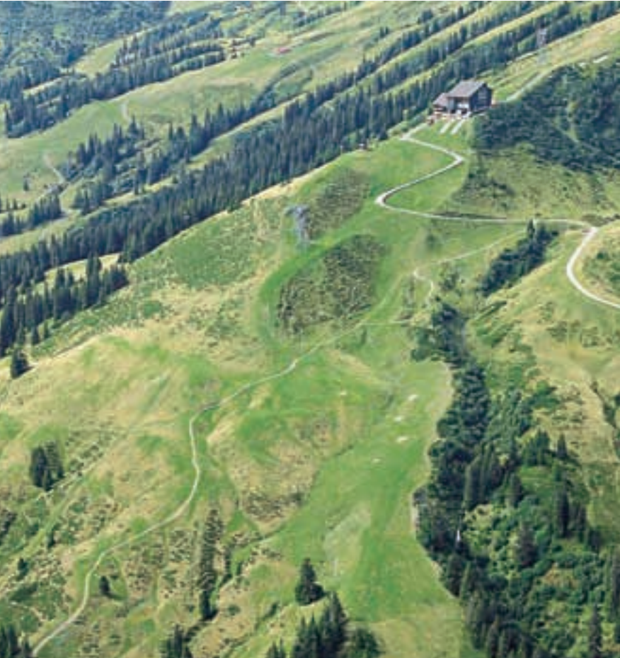
Foto 4: Mit Baumaschinen gebaute Pisten sind aufgrund ihrer veränderten Boden- und Vegetationsstruktur auch im Sommer deutlich erkennbar (OA16 Fellhorn).
