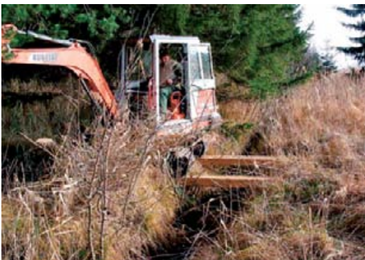
Abbildung 27: Kettengetriebene Kleinbagger sind sehr wenig und können ohne größere Schäden auch in stärker bewaldetem Gelände eingesetzt werden.
