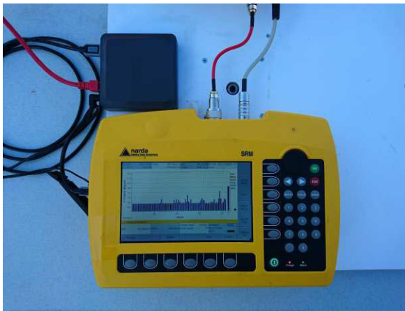
Abb. 6: Der Narda-Spektrumanalysator SRM-3006 analysiert die Funksignale und ermittelt deren elektrische Feldstärken. Die beiden Anschlüsse dienen dem Antennensignal sowie der Abfrage von Kabeldämpfung und Antennengewinn aus EEPROMs, die in allen Narda-Kabeln und -Antennen integriert sind. Das Gerät ist dadurch selbstständig in der Lage, den am Signaleingang anliegenden Spannungspegel in eine elektrische Feldstärke umzurechnen.
