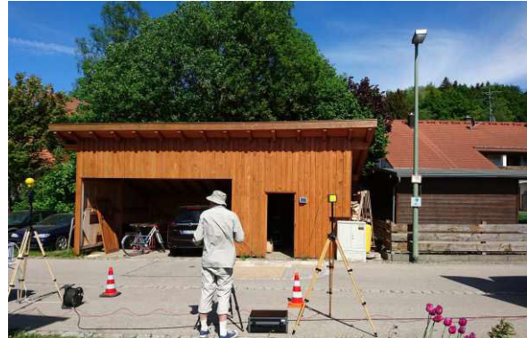
Abb. 33: Messpunkt mit dem höchsten Ausschöpfungsgrad niederfrequenter Magnetfelder (MP037; Q_B = 11,1\% ). Ursächlich ist ein Unterverteiler direkt am Messpunkt (links neben der Straßenlaterne).
