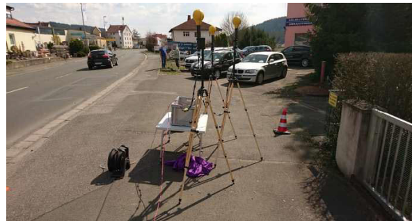
Abb. 59: Besondere Messpunkte des Mobilfunks 2017/2018: An diesem Messpunkt im oberfränkischen Kronach (MP239) liegen die höchsten GSM- und damit auch insgesamt die höchsten Mobilfunkimmissionen vor. Die verursachende Anlage ist auf dem Haus zu erkennen, das in der Flucht des Straßenverlaufs liegt.
