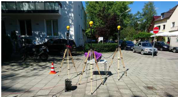
Abb. 58: Besondere Messpunkte des Mobilfunks 2017/2018: Die Mobilfunkanlage (nicht im Bild) auf dem Dach des rechten Hauses sorgt an diesem Messpunkt (MP048) in München für die höchsten UMTS-Immissionen.
