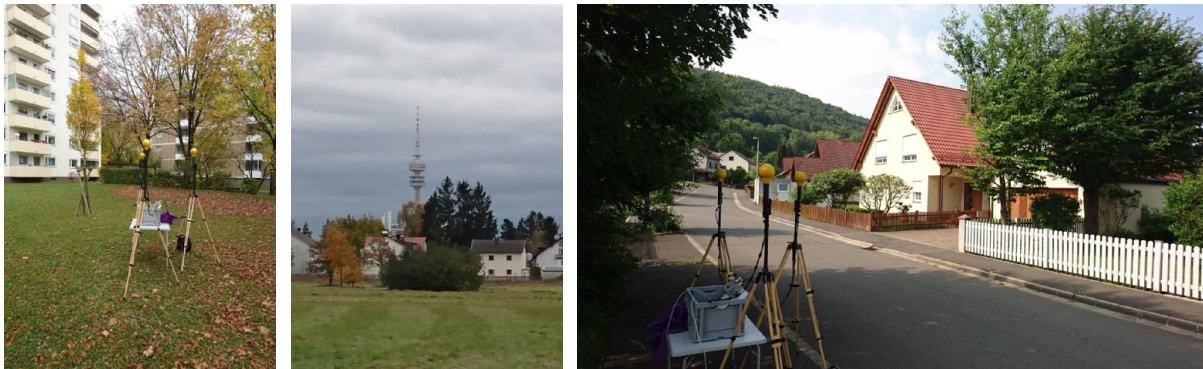
Abb. 48: links: Messpunkt mit dem höchsten thermischen Ausschöpfungsgrad beim Hörfunk, Messpunkt 075; Q_{E2} = 105 \cdot 10^{-6} . Vom Messpunkt aus besteht Sichtverbindung zum Münchener Olympiaturm
