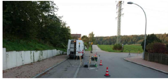
Abb. 38: Messpunkt mit dem zweithöchsten Ausschöpfungsgrad (MP349; Q_E = 260 \text{ ‰} ; Exposition durch die vorbeiführende Freileitung).
