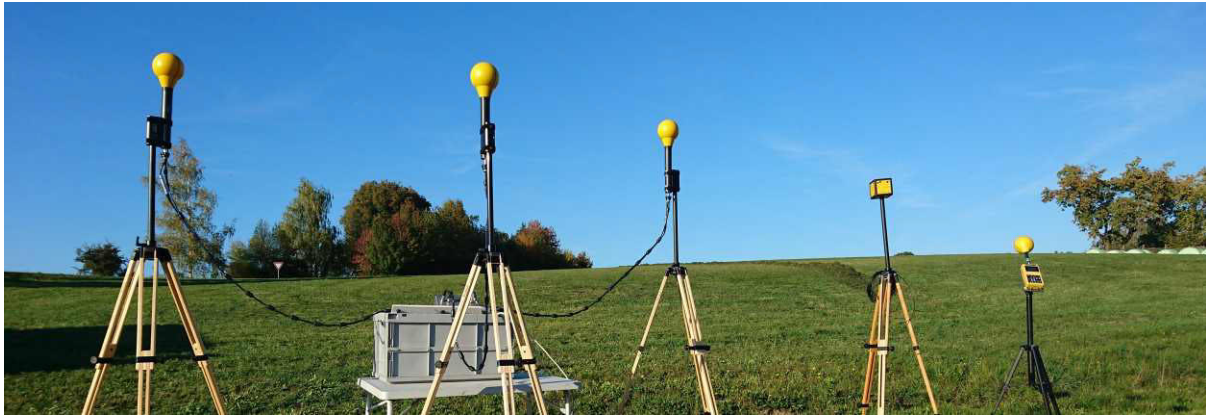
Abb. 4: Exemplarischer Aufbau des neuen Messsystems. Von links nach rechts: Magnetfeldantenne für den Frequenzbereich 9 kHz – 250 MHz, E-Feld-Antennen für die Frequenzbereiche 27 MHz – 3 GHz und 420 MHz – 6 GHz, sowie die Sonden für niederfrequente elektrische und magnetische Felder von 5 Hz bis 32 kHz, die schon bislang zum Einsatz kamen.
