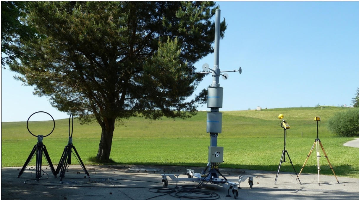
Abbildung 3-1: Messaufbau beim EMF-Monitoring. V. l. n. r.: Loop-Antennen (LW/MW/KW), Antennenturm für den Frequenzbereich zwischen 20 MHz und 3,0 GHz, Sonden für niederfrequente magnetische Felder und niederfrequente elektrische Felder bis jeweils 32 kHz.
