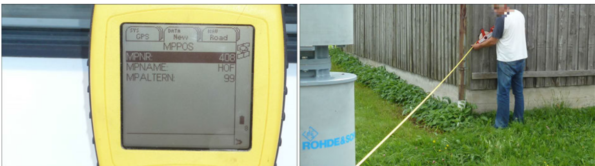
Abbildung 3-7: In der Messreihe 2011/2012 wurde an allen Messpunkten per GPS die geographische Lage bestimmt (links) sowie die Entfernung von dem Antennenturm zu zwei Fixpunkten in der Umgebung gemessen (rechts).
