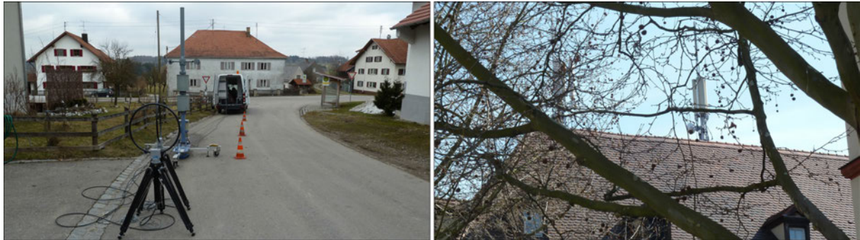
Abbildung 7-7: Messpunkte mit dem niedrigsten (links Messpunkt 028; Q_{E2} = 0,001 \cdot 10^{-6} ) und höchsten (rechts Messpunkt 119; Q_{E2} = 2640 \cdot 10^{-6} ) thermischen Ausschöpfungsgrad beim Mobilfunk. Der rechte Messpunkt befindet sich in unmittelbarer Nähe zu der abgebildeten Basisstation.
