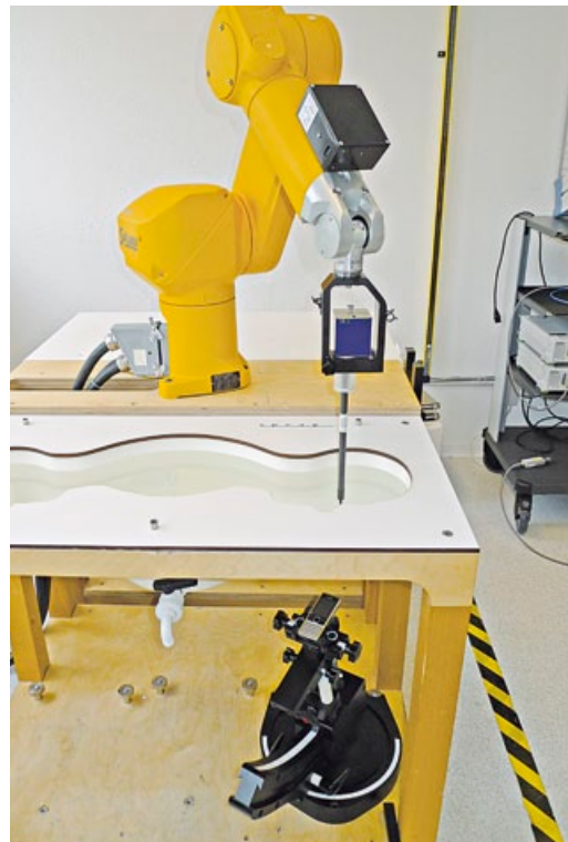
Messung des SAR-Wertes eines Handys: Die Messsonde am Ende des gelben Roboterarms ermittelt im flüssigkeitsgefüllten Phantomkörper (weiß) den Ort der höchsten Feldstärke.
