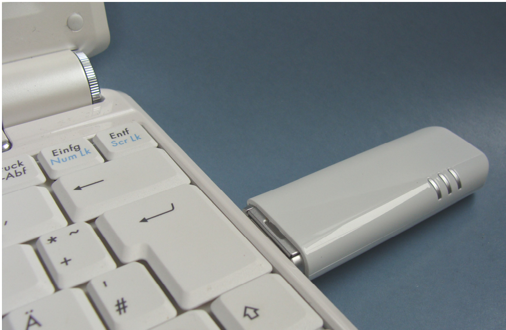
Abb. 1: Mobiler Internetzugang mittels UMTS-Stick am USB-Anschluss
