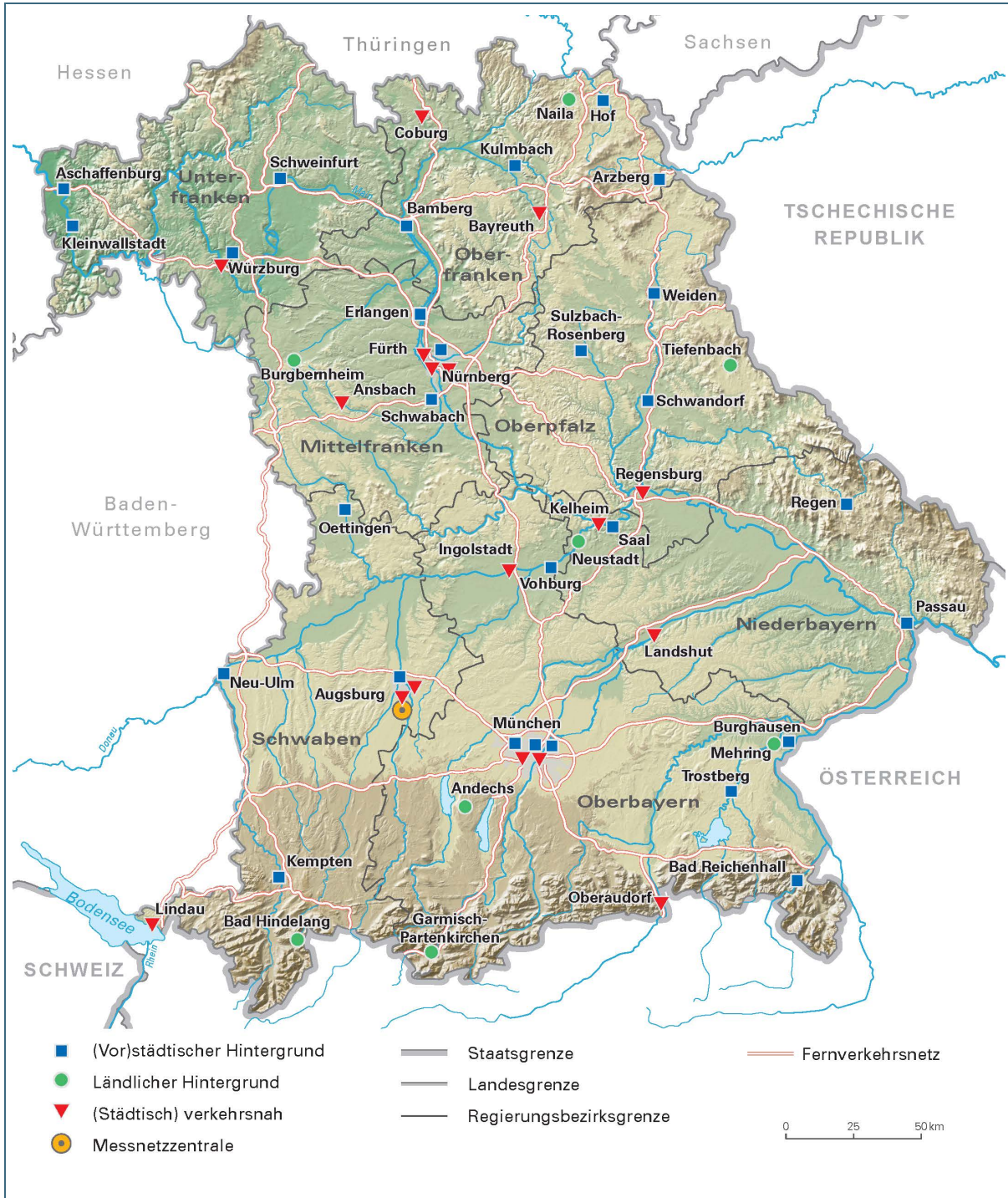
Abb. 1: Karte mit den Messstationen des Lufthygienischen Landesüberwachungsystems Bayern (LÜB)
