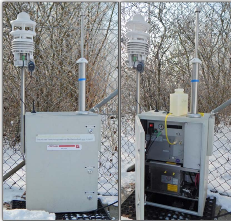
Abb. 4: Vorderansicht EDM 465 UFPC; links: geschlossen, rechts: geöffnet während der Auffüllung des Butanol- reservoirs
