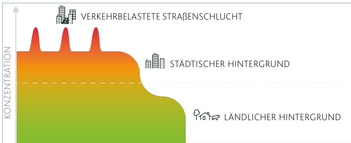
Abb. 20: Schema der Luftschadstoffbelastung in einem städtischen Ballungsraum, die sich aus dem regionalen (grün) und dem urbanen (orange) Hintergrund sowie einer lokalen Belastung wie beispielsweise dem Verkehr an einer Hauptstraße (rot) zusammensetzt. [10]
