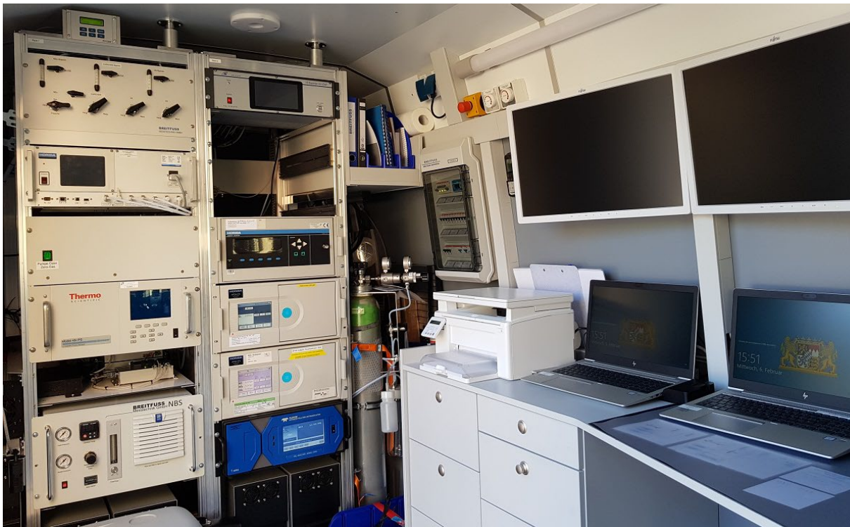
Abb. 17: Blick in ein Kalibrierfahrzeug des LÜB. Die Messgeräte sind im Rack (links) eingebaut, rechts davon befindet sich ein Bildschirmarbeitsplatz, um die Messwerte zu verfolgen.
