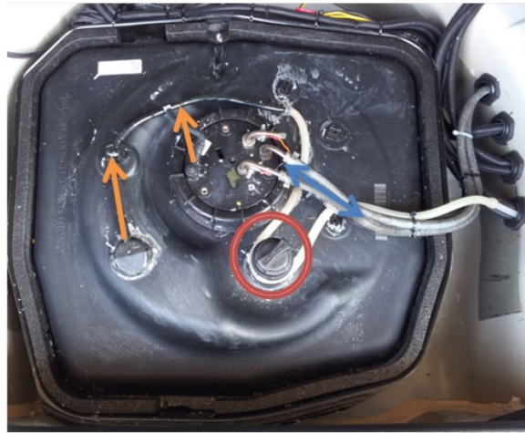
Abbildung 3: AdBlue®-Tank in der Reserveradmulde
