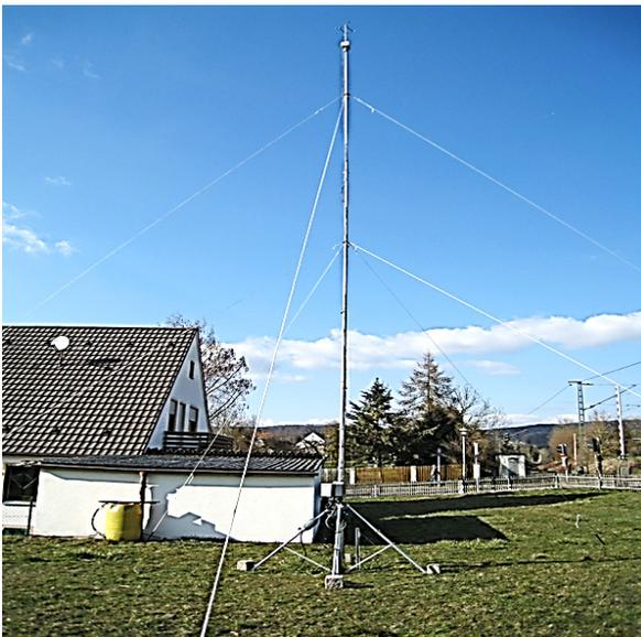
Abb. 8: Die Abbildung zeigt den 10 m hohen Windmast in der Nähe des Messpunktes Märkergarten, Blick Richtung Norden
