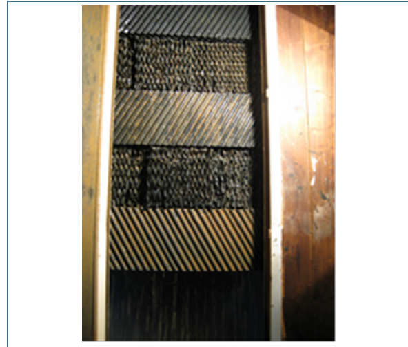
Abb. 14: Füllkörper eines Rieselbettreaktors
