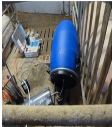
Abb. 43: Geruchsprobenahme im Rohgas statisch nach Lungenprinzip
