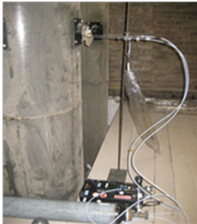
Abb. 42: Geruchsprobenahme im Reingas mit dynamischer Vorverdünnung
