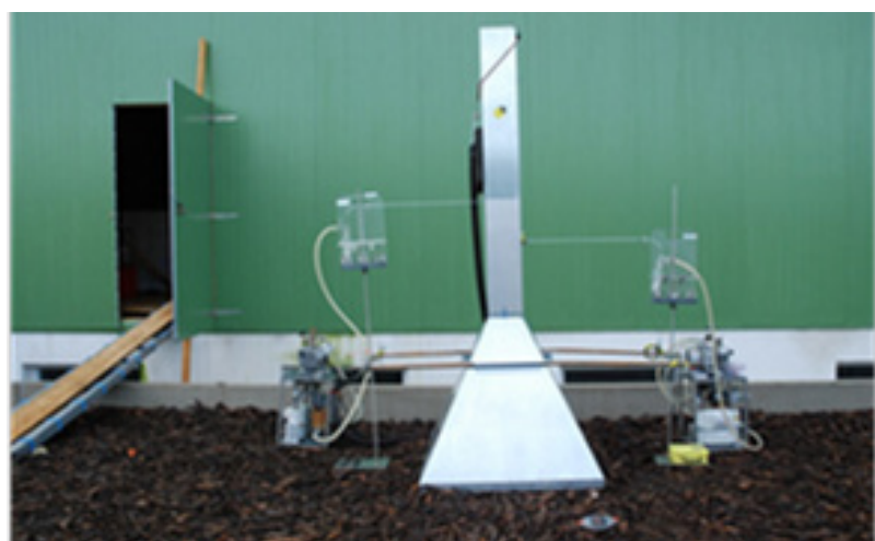
Abb. 28: Doppelbestimmung der Bioaerosolgehalte (mit Messhaube am Biofilter)
