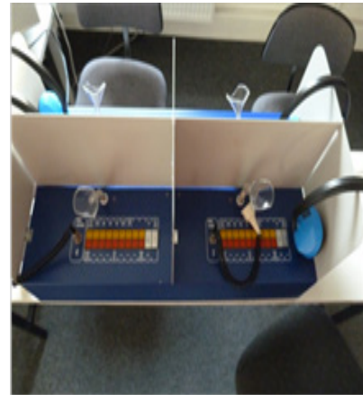
Abb. 44: Olfaktometer mit vier Probandenplätzen
