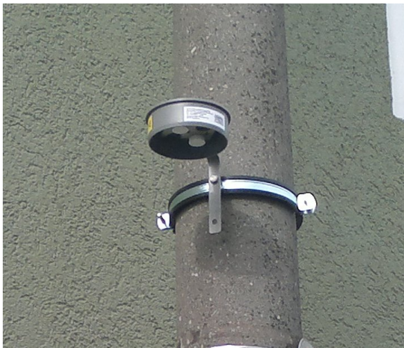
Abb. 2: Wetterschutzgehäuse mit Passivsammlern; die beiden Sammelein- heiten sind als weiße Plastikkapseln gut zu erkennen
