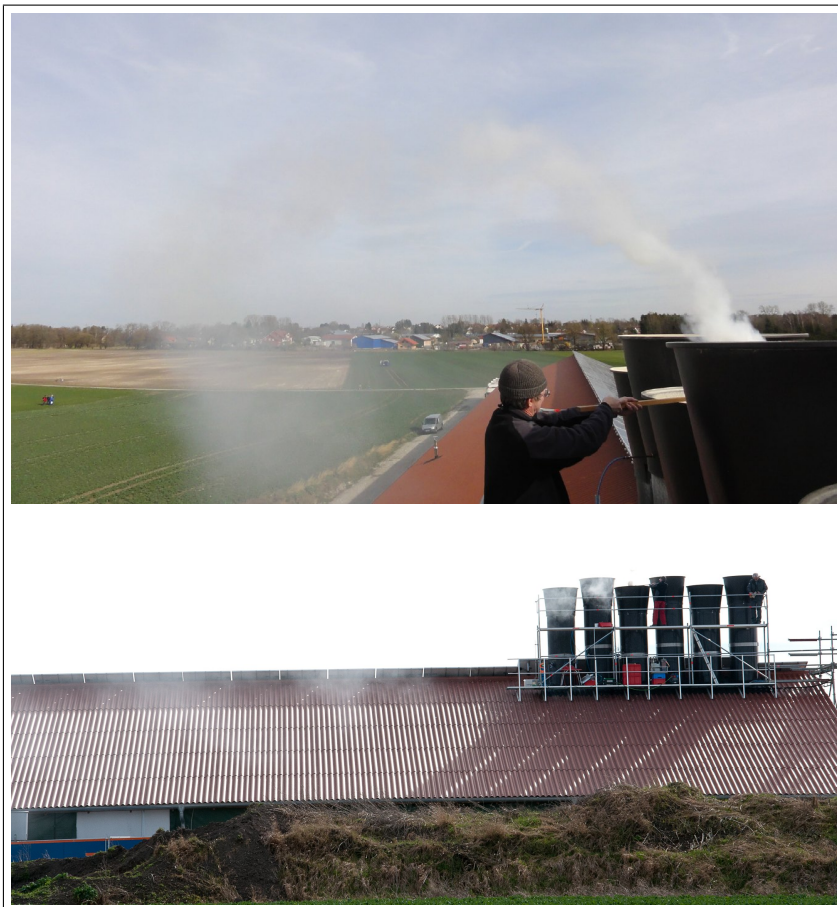
BILD 5: Darstellung der Strömungsverhältnisse am Nachmittag mit Hilfe von Rauchversuchen (die Bilder wurden zu unterschiedlichen Zeitpunkten aufgenommen). Bild oben IBL, Bild unten UJ.
