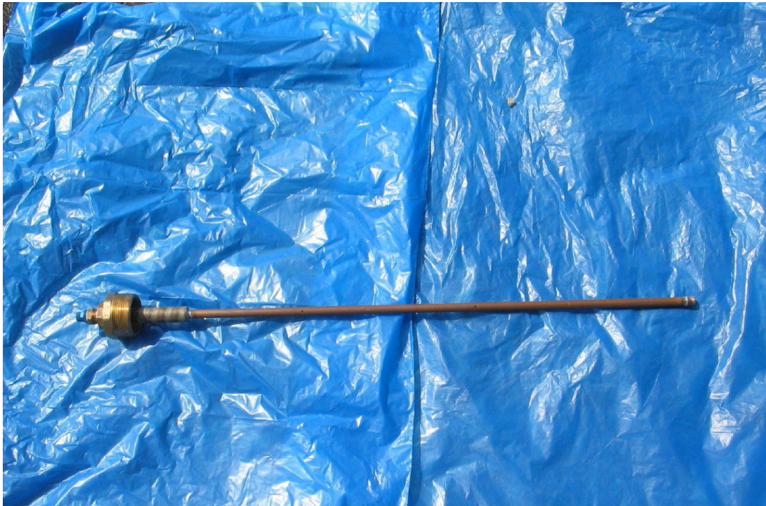
Abb. 4.6: Ansicht der Emissionsquelle SF 6 außerhalb des Schachts
