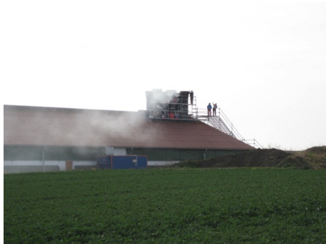
Abb. 75: Rauchversuche zur Sichtbarmachung der Abgasfahnenüberhöhung bzw. -ausbreitung
