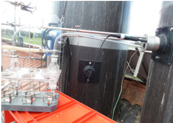
Abb. 23: Probenahme mit einem Emissions-Impinger
