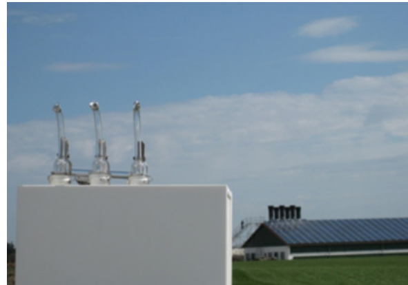
Abb. 24: Eine Immissions-sammelprobe mit drei parallel angeordneten Immissions-Impingern
