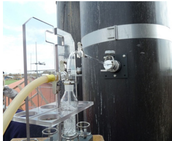
Abb. 8: Bioaerosol-Probenahme mit einem Emissions-Impinger an Kamin 2
