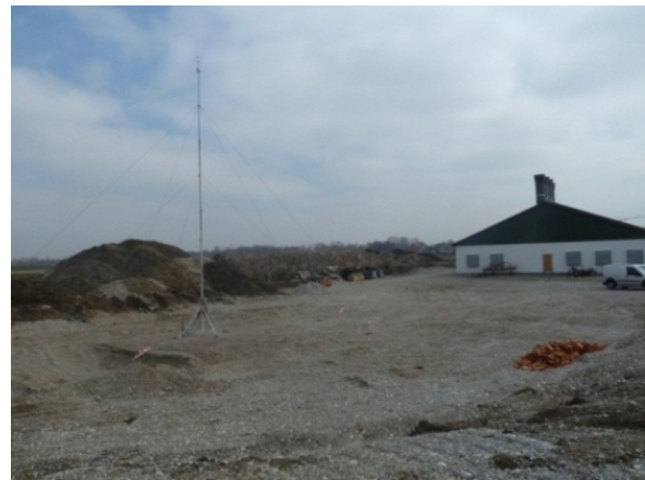
Abb. 21: Standort des 10 m hohen Windmastes (USA1- Ultraschall-Anemometer)
