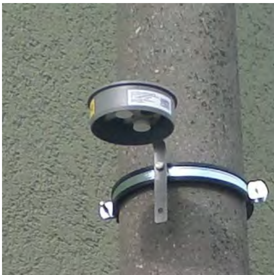
Abb. 2: Passivsammler zur Messung von NO 2
