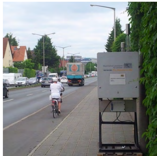
Abb. 3: Airpointer zur mobilen Messung von NO, NO 2 und Ozon
