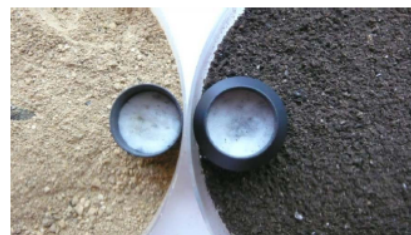
Staubabscheidung im Filter bei nachfolgenden Driftmessungen 0,5 mg
