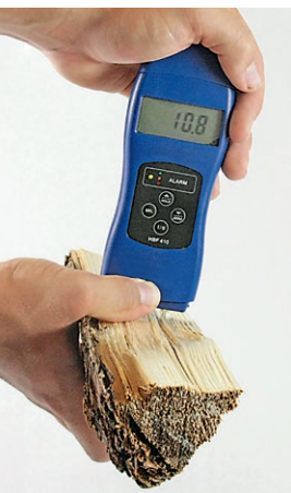
Messung des Wassergehaltes mit einem Schnellbestimmungsgerät
