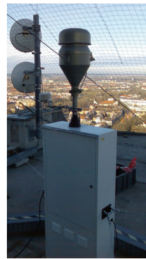
Abb. 6: Staubprobeaufnahme auf dem „Hotel-turm“ in 100 m Höhe zur Ermittlung der Hintergrundbelastung
