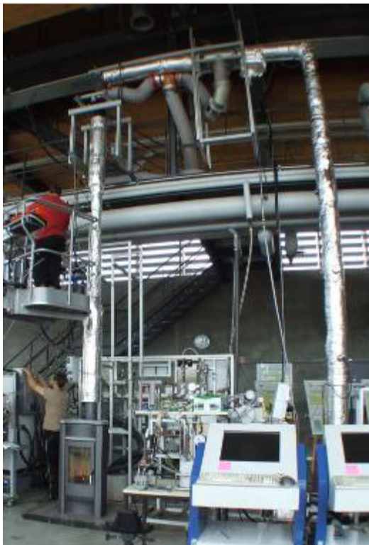
Abbildung 2.2-3: Emissionsmessung am Prüfstand des TFZ mit Verdünnungstunnel
