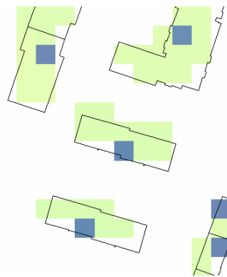
Abbildung 2.5-2: Grundrisse der Gebäude in Vektordarstellung (schwarz) und gerastert (grün) mit den Emissionsquellen des statistischen Emissionsquellenmodells (blau)
