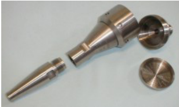
Abbildung A.1-2: Planfilterkopfgerät nach VDI 2066
