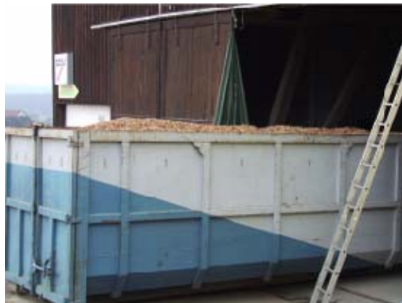
Abbildung 10-4 Container zur Holzhackschnitzeltrocknung
