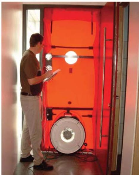
„Blower-door-Test“ zur Überprüfung
