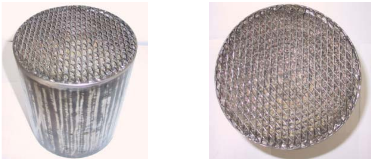
Abbildung 11: Filtersystem „Bb“ – gewickeltes Draht-/Keramikfilamentgestrick
