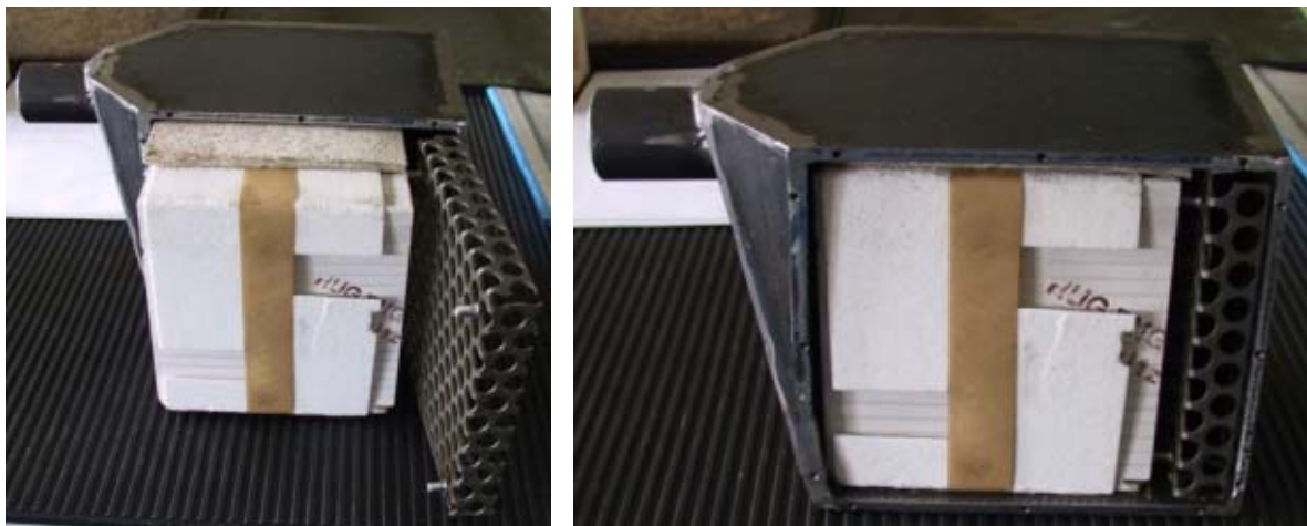
Abbildung 7: Oxidationskatalysator zur Regeneration mit \text{NO}_2 für die Partikelfilter „Da“, „Db“ und „Dc“
