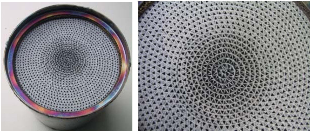
Abbildung 13: Dieselpartikelfiltersystem „D“ – spiralförmig aufgewickelte Keramikfaserverbundbahn mit wechselseitig verschlossenen Kanälen in Edelstahlgehäuse
