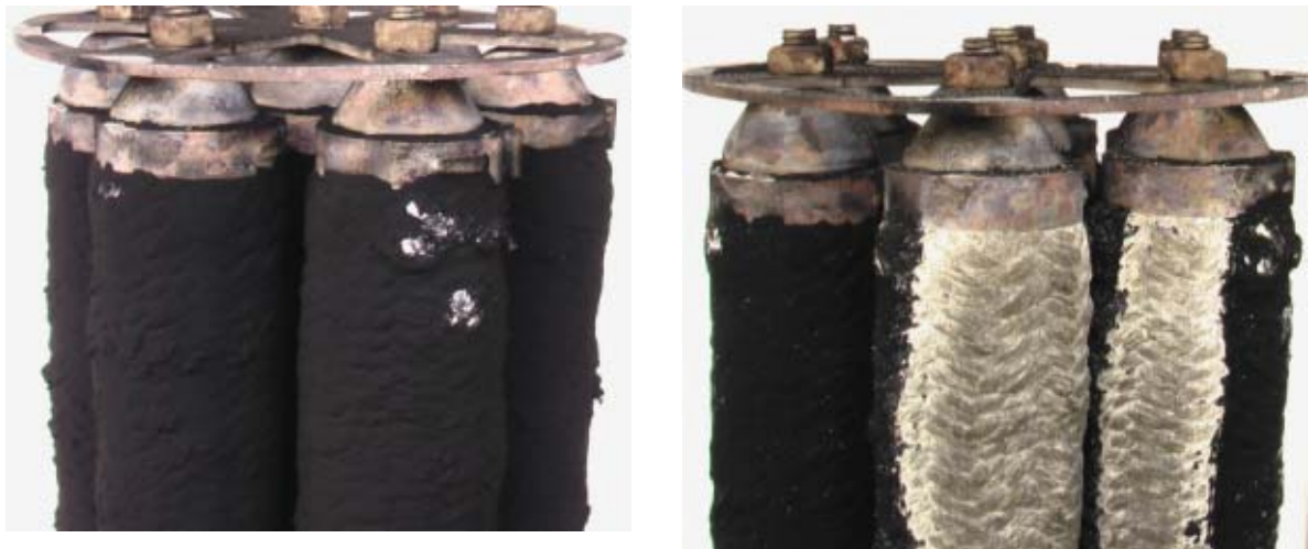
Abbildung 33: Filterkerzen des Partikelfiltersystems „E“ in beladenem Zustand (links) und teilweise gereinigt (rechts)
