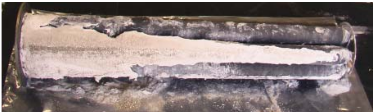
Abbildung 32: Abgaspartikelfilter „E“ mit sandartigem Material des beschädigten Oxidationskatalysators
