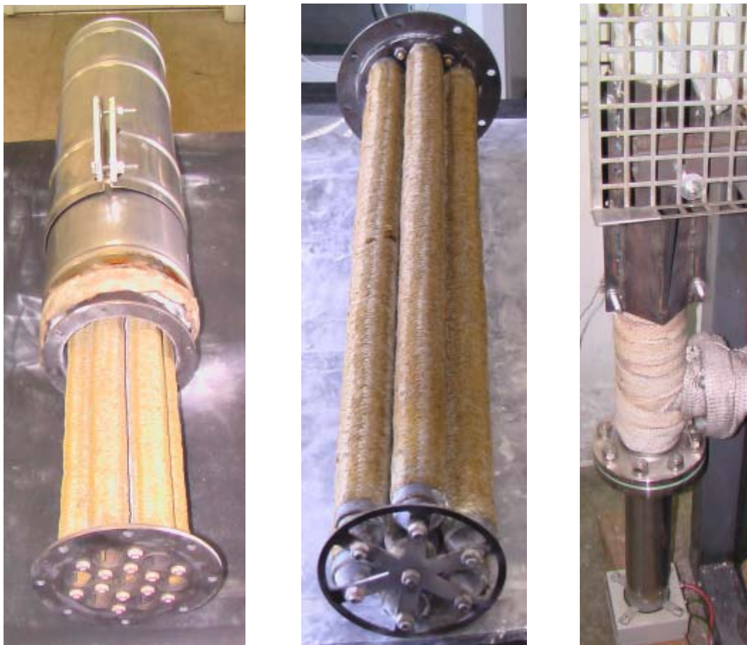
Abbildung 15: Abgaspartikelfiltersystem „E“ mit katalytisch beschichteten Glasfasergeflechtfilterkerzen (links und Mitte) und vorgeschaltete elektrische Abgasheizung (rechts).
