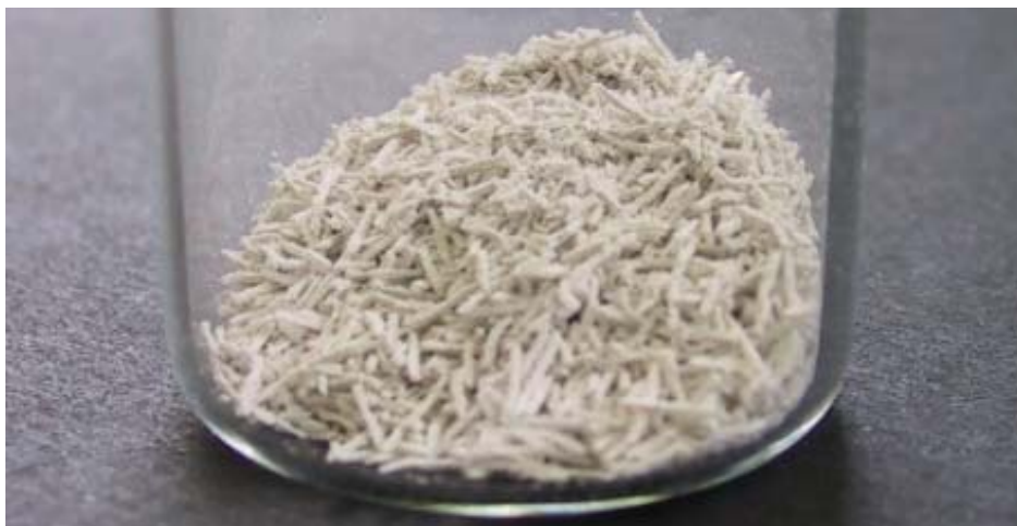
Abbildung 23: Ascherückstand aus dem Dieselpartikelfilter „A“
