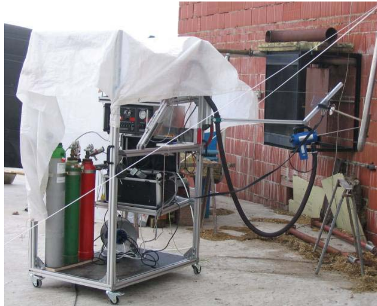
Abb. 12: Rüstsatz B zur Bestimmung der Abgaszusammensetzung
