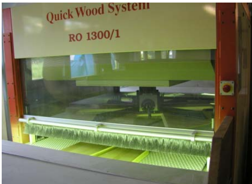
Einreibemaschine, das den Ölauftrag gleichmäßig einreibt
