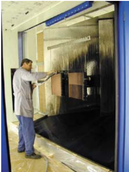
Lackrückgewinnung durch Kondensation
