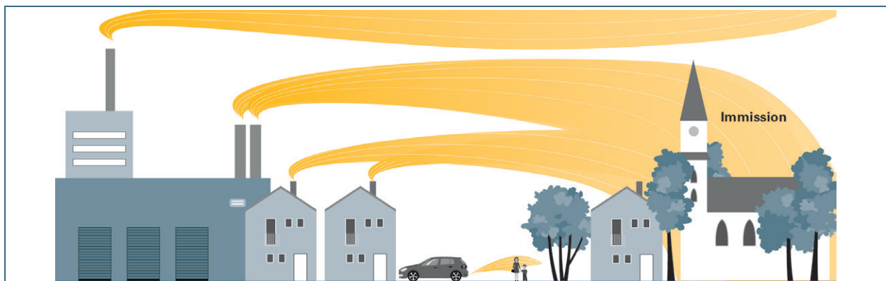
Abb. 1: Abgase stammen nicht nur aus Industrie, sondern auch aus Hausfeuerungen und aus dem Verkehr (Emissionen). Im Nahbereich wirken vor allem Schadstoffe aus bodennahen Quellen (Immission). Je höher der Kamin, desto weiter werden Schadstoffe transportiert. Dabei werden sie häufig chemisch umgewandelt (verändert nach Baumbach 1990).
